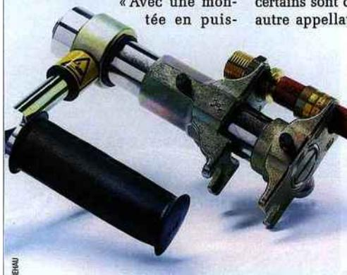
Réalisation d'un assemblage par sertissage axial : expansion de l'extrémité du tube, puis glissement de la bague.
